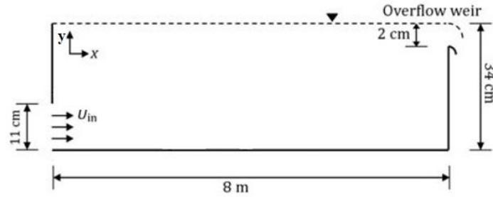
**Figure 1:** Tank dimensions
